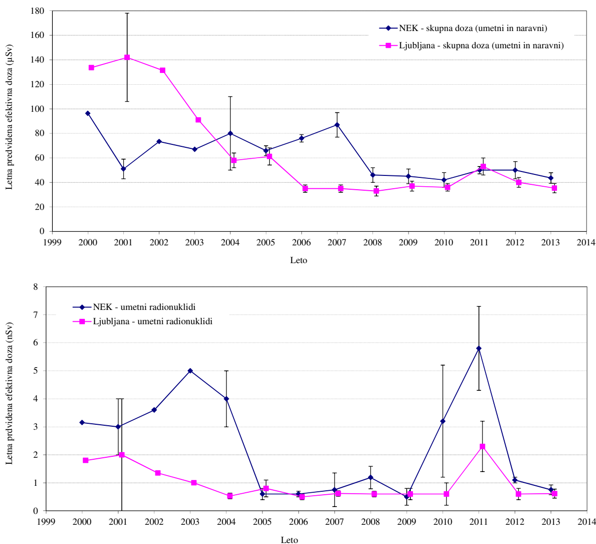
Slika 5.5: Primerjava predvidenih letnih učinkovnih doz v okolici NEK in Ljubljani za odrasle osebe iz meritev aerosolov za naravne in umetne radionuklide skupaj (slika zgoraj v enotah \mu\text{Sv} ) in posebej za umetne radionuklide (slika spodaj v enotah nSv). Vrisane negotovosti imajo faktor pokritja 68 %.
