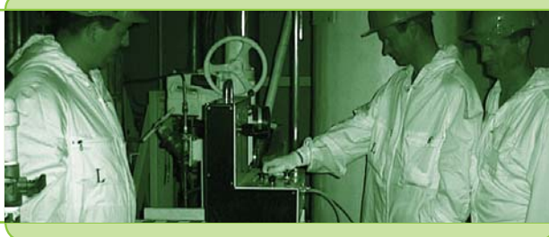
merjenje puščanja izolacijskih ventilov zadrževalnega hrama 3.2*
