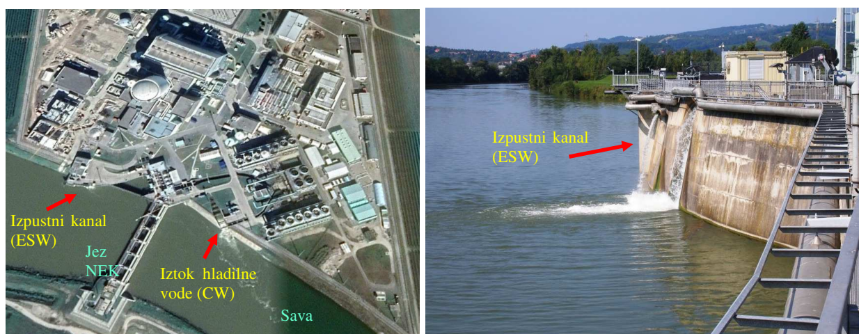
Slika 1.1: Izhod bistvene oskrbne vode (ESW), kjer se izpuščajo radioaktivne tekočine iz odpadnih merilnih rezervoarjev (WMT) in sistema za kaluženje uparjalnikov (SGBD). Fotografija na desni je posneta z jeza NEK.
